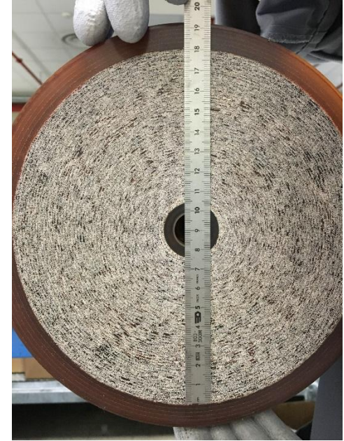
Assemblage de fibres (module) Coupe transversale de la membrane
