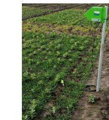
Sondes gravimétriques dans une CIVE d'hiver pour le suivi de la consommation en eau
