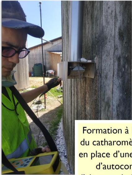
Formation à l'utilisation du catharomètre et mise en place d'une procédure d'autocontrôle à l'absence de fuite biogaz (1/2 journée)
