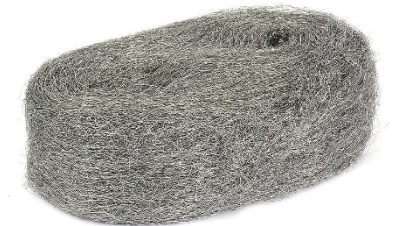
Agent Chauffant - Paille de fer SAR (48 mT, 100 kHz) ≈ 50 W/g
