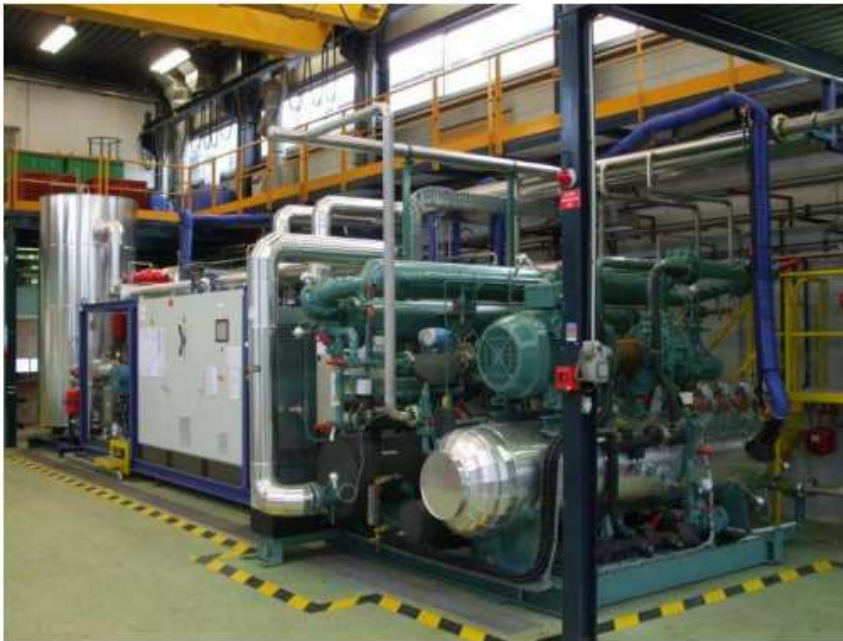
Photo du simulateur expérimental intégrant la pompe à chaleur dans le laboratoire
