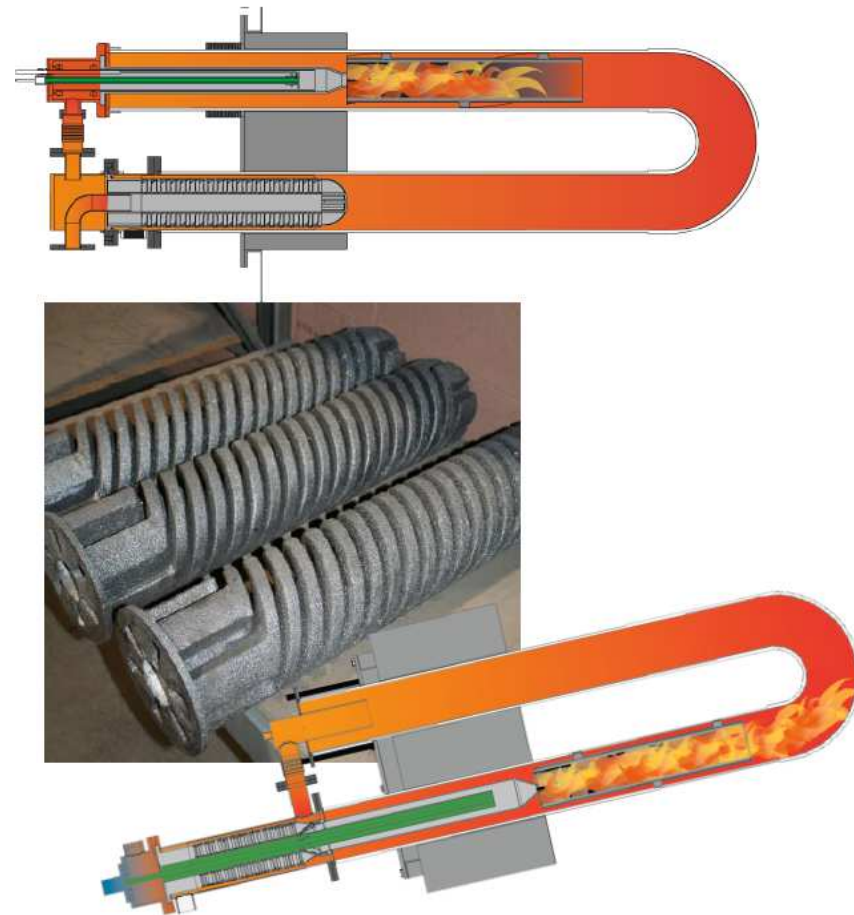
Echangeur en carbure de Silicium haute température
