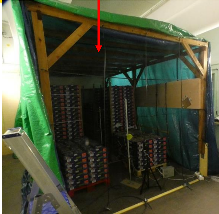
Passage de l'air uniquement par le couloir
