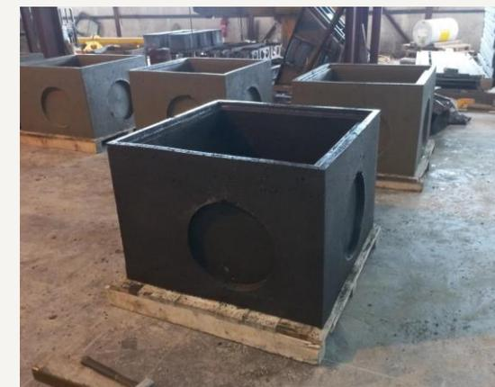
Regard pour les eaux pluviales (VRD) –Préfabricant Sobemo (73)
