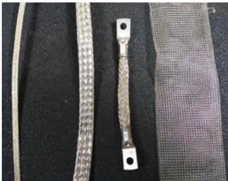
Figure 13 : Vue de tresses de liaison équipotentielle
