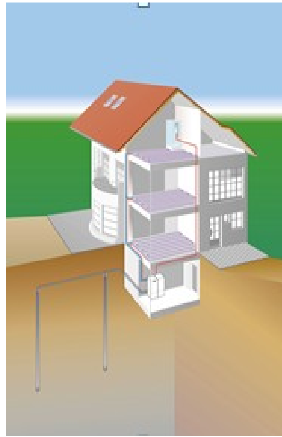
Sondes géothermiques Géothermie sur SGV Sonde Géothermique Verticale
