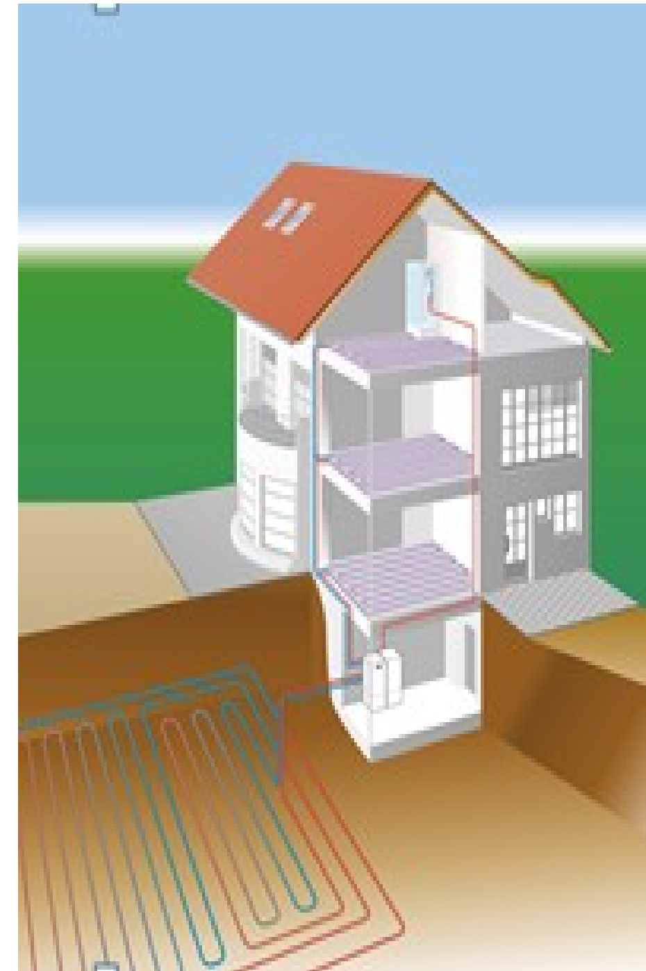
Collecteurs enterrés Héliothermie
