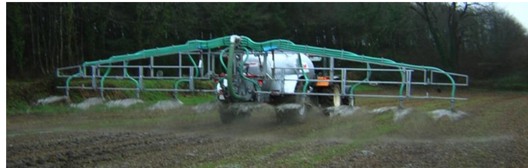
Rampe à buse
