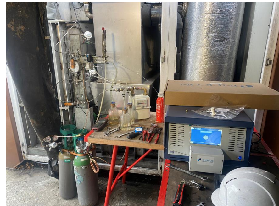
Dispositif de prélèvement et d'analyse en continu du syngas
