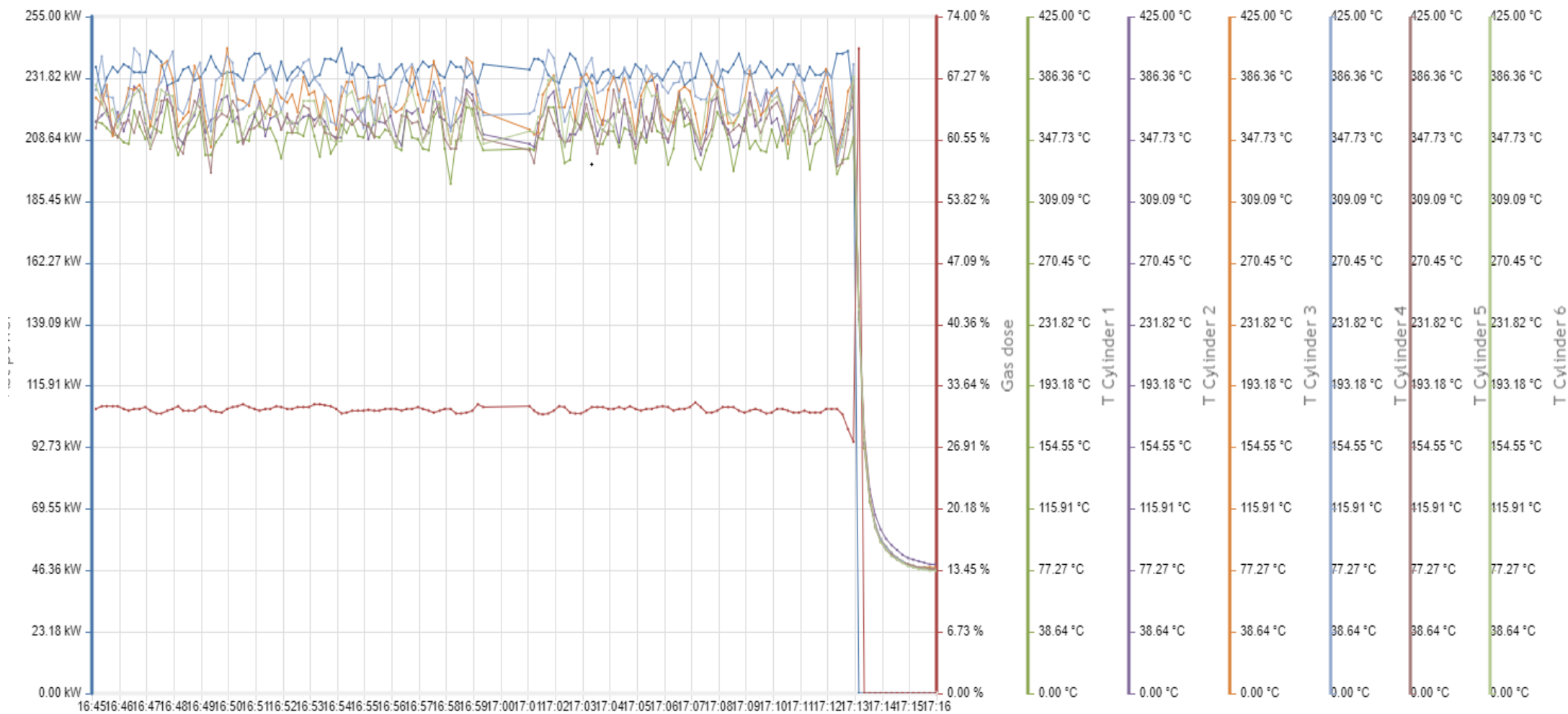
Température instable des cylindres
