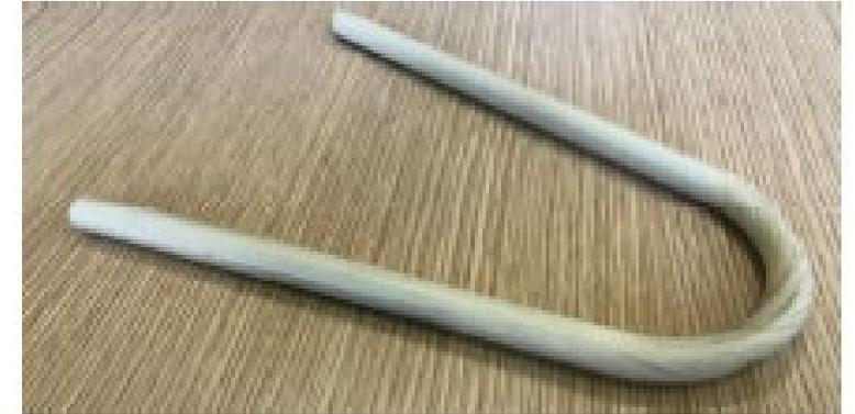
Barre de 6 mm de diamètre avec fibre de verre après ceintrage
