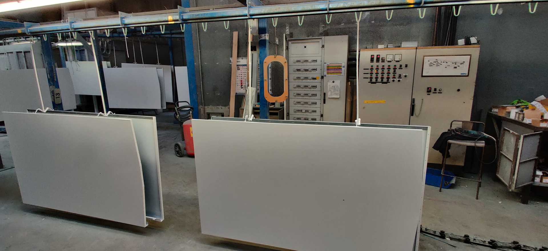
1 Accrochage des plaques métalliques
