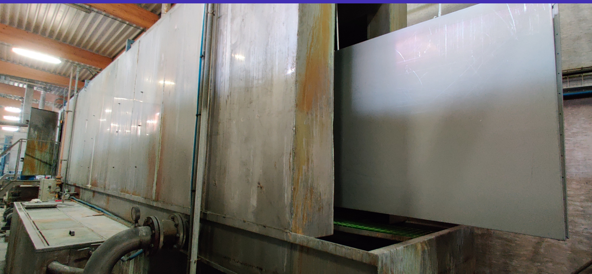
3 Process de lavage avant le séchage et la peinture
