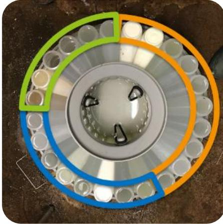
Série de prélèvements en sortie d'une opération de Nettoyage En Place
