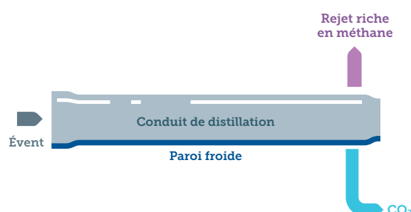
▷ FIG. 7 : SCHÉMA DE PRINCIPE DE LA DISTILLATION CRYOGÉNIQUE
