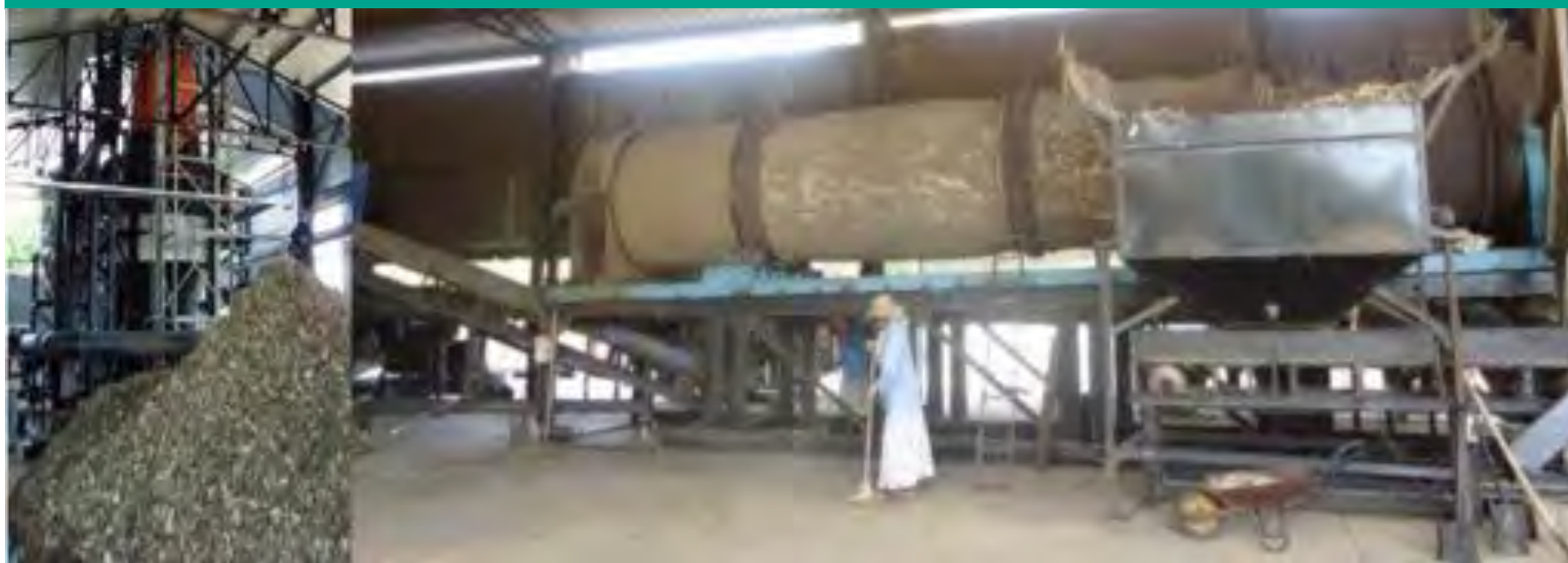
Séchage des intrants – Humidité < 20%
