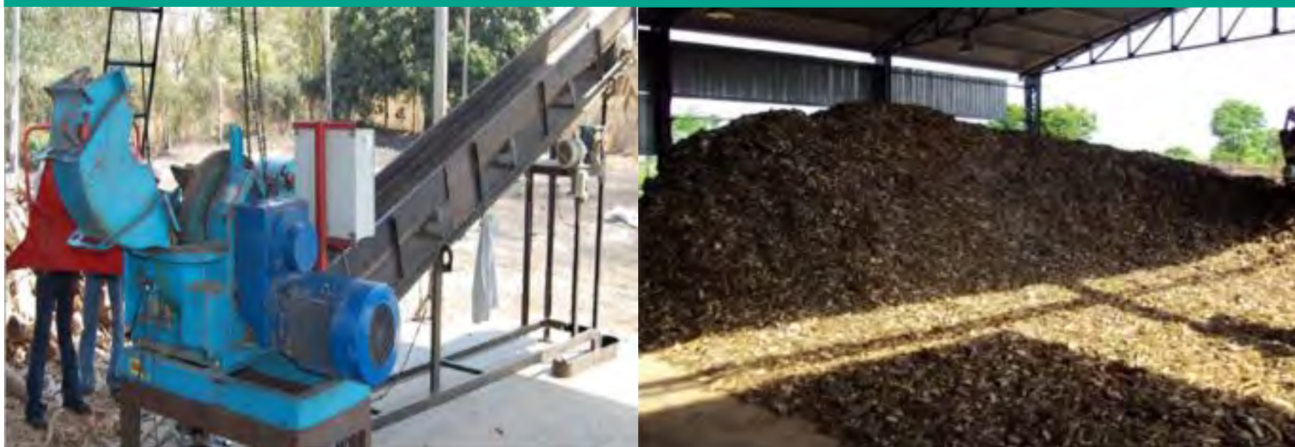
Broyage des intrants – Granulométrie 25 à 75mm
