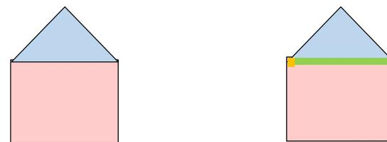
Dans le schéma suivant, les combles sont chauffés. Dans ce cas, seule l'isolation des rampants de toiture (en vert) et à la rupture des ponts thermiques (en jaune) est éligible aux fiches BAR-EN-101 et BAT-EN-101, comme représenté sur le schéma.
