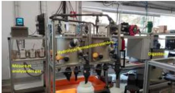
Pilotes pour l'étude de l'influence des conditions d'hydrolyse sur la méthanisation (Hydroboost et boosthydro)
