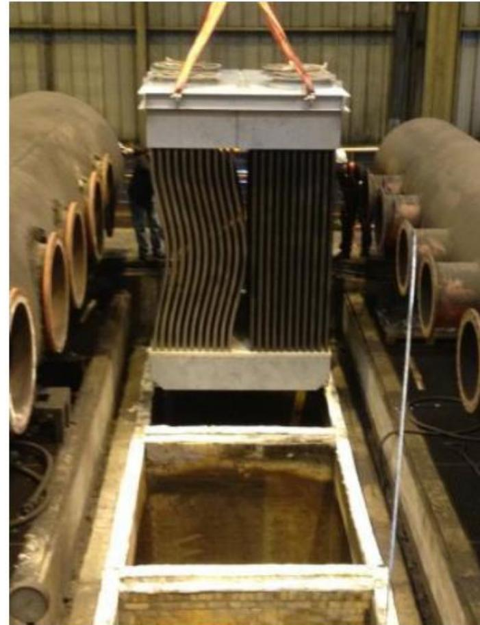
**Echangeur de préchauffage d'air sur fumées de fours à gaz**
