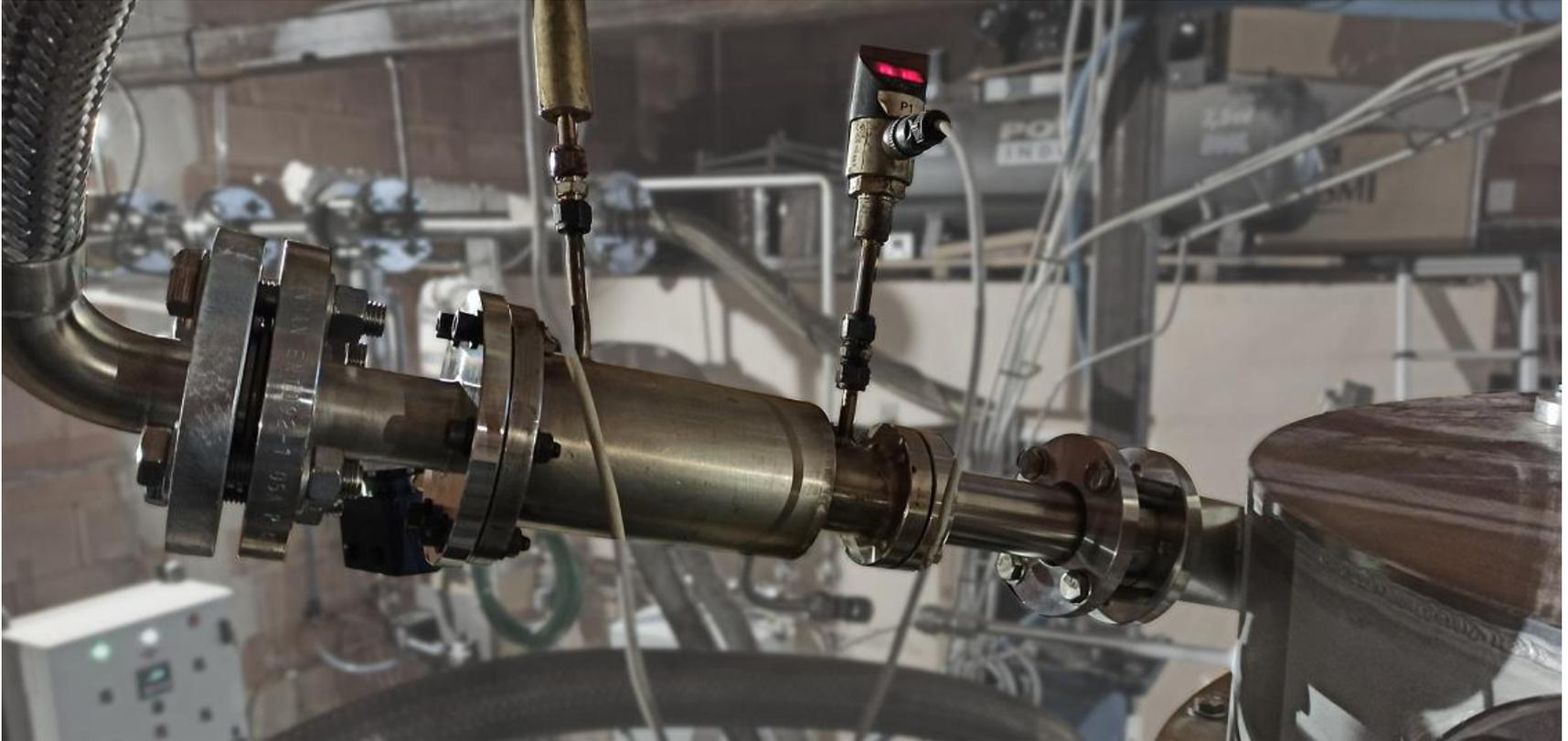
**Les dernières avancées de HEVATECH concernent le développement d'un injecteur de plus forte puissance (25 kW) le but est d'arriver à une turbine de plusieurs centaines de kW.**
