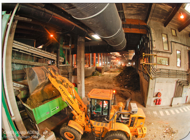
Méthanisation - transfert vers le digesteur
