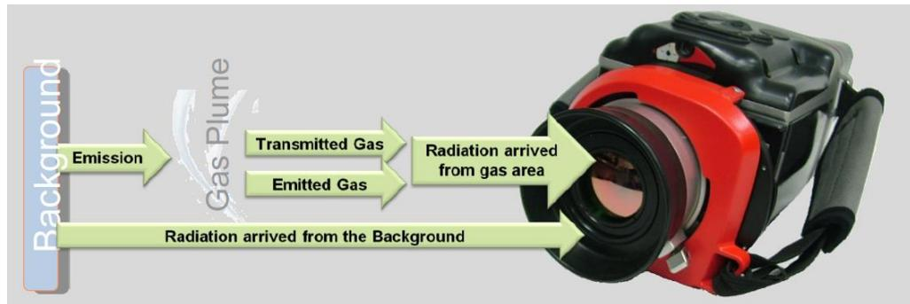
La caméra détecte la différence de radiation, entre celles provenant de l'arrière plan et celles qui ont traversées le «nuage» de gaz, qu'elle «traduit» en image faisant apparaître le gaz sur son écran intégré.
