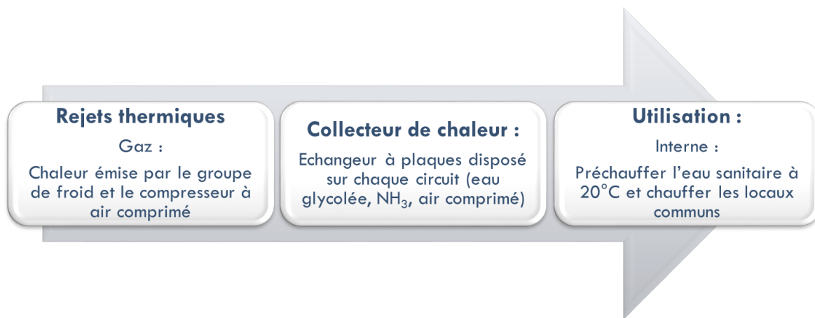
Figure 2: Schéma de la solution de récupération de chaleur fatale
