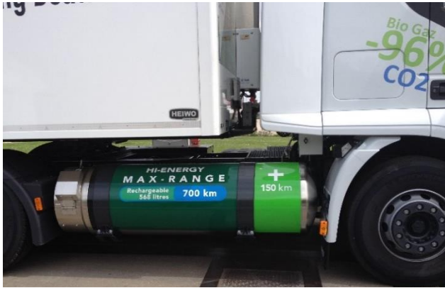
Crédits photo : Club Biogaz ATEE. Camion IVECO alimenté par du bioGNL issu du projet bioGNVAL sur l'usine de Valenton (SIAAP, SUEZ, ADEME)
