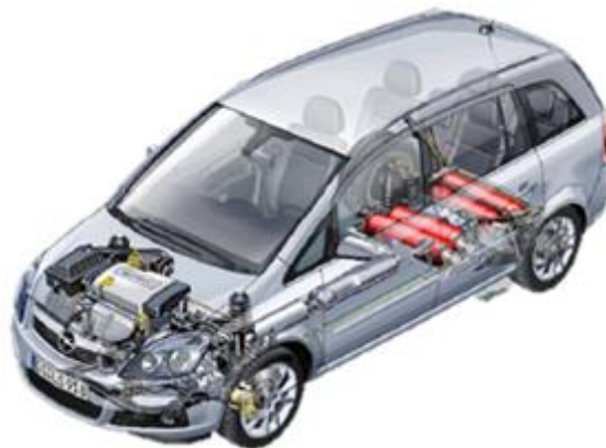
Véhicule GNV (Réservoirs en rouge)
