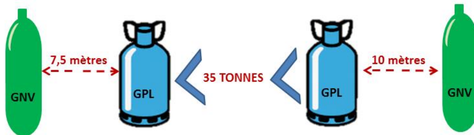
Distance de sécurité de stockage de GPL et de GNV
