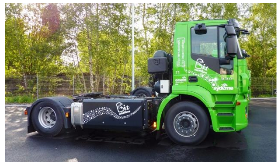
Figure 157 : Tracteur routier roulant au biométhane carburant - Source : IVECO
