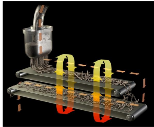
Figure 193 : Fonctionnement du sécheur à bande STC - Source : STC
