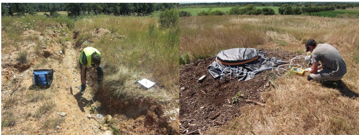
Figure 127 : Mesures ponctuelles et surfaciques d'émissions fugitives de biogaz Source : CSD Ingénieurs
