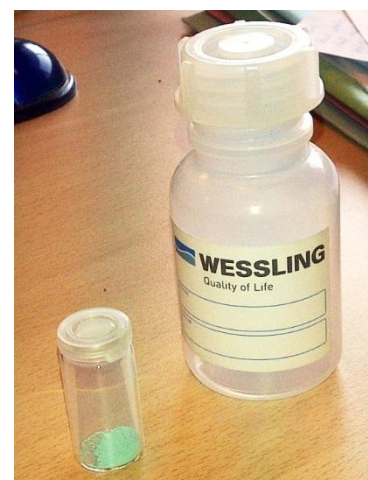
Figure 109 : flaconnage avec stabilisateur pour la conservation des échantillons de substrat Source : WESSLING
