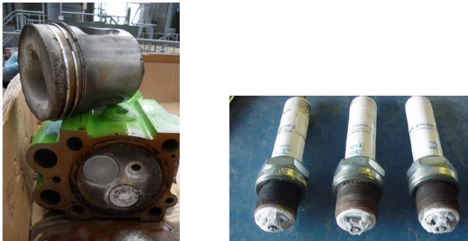
Figure 168 : Dommages engendrés par les siloxanes - Source : PpTek
