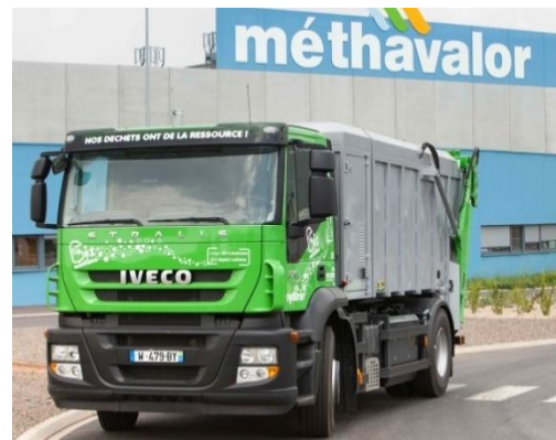
Figure 160 : Porteur 19t dédié à la collecte des biodéchets roulant au biométhane carburant Source : IVECO
