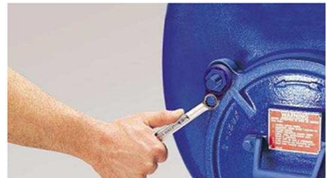
Figure 37 : Dévissage des écrous de maintien de la pompe Gorman-Rupp® Source : Hydro-Group
