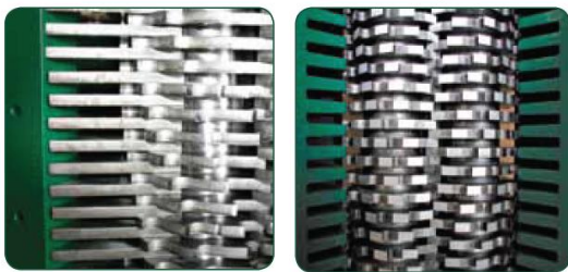
Figure 52 : Peignes (à gauche), et guides latéraux de flux (à droite) des broyeurs Monster® Source : Hydro-Group
