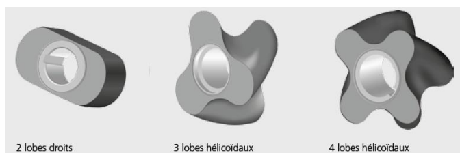
Figure 43 : Rotors à différents nombre de lobes Source : NETZSCH
