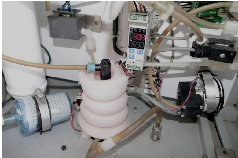
Figure 102 : Le conditionnement du biogaz: au centre se trouve un condenseur et piège à humidité, sur la gauche un dessiccateur – Source : Bio-CH4.com
