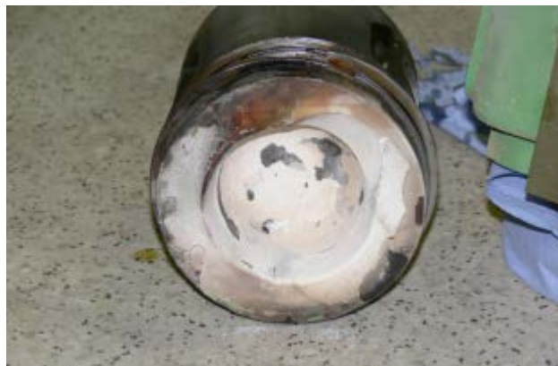
Figure 2: Colmatage d'un piston d'un moteur à gaz
